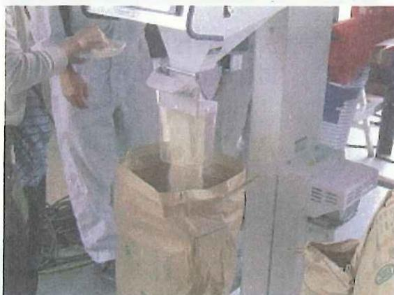
飼料用米破碎機で破碎した米の排出
